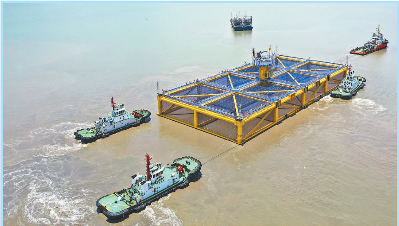
大黄鱼深海养殖平台“宁德1号”驶向福建宁德市霞浦县北礵岛海域养殖区。该平台装配自动投喂、气温海水监测、信息化自动控制等先进系统,推动宁德大黄鱼养殖产业发展。 王志凌摄(新华社发)
