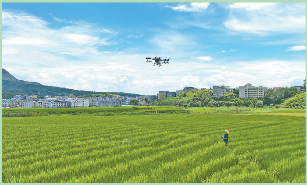
湖南郴州市桂阳县塘市镇杂交水稻制种基地,农技员操控植保无人机为杂交水稻制种授粉。相比传统的人工用竹竿、绳子等“赶花”授粉的方式,无人机制种授粉效率更高、成本更低、质量更好。 周秀鱼春摄(影像中国)
