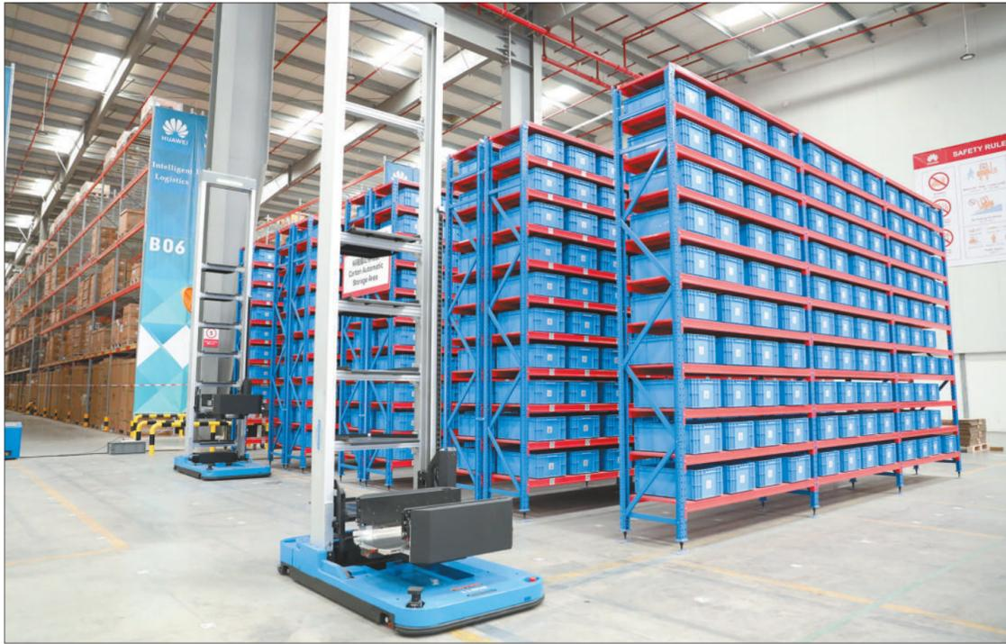
穿梭,按照工作人员通过手持终端下达的指令,将一件件货物及时准确地搬运至指定位置。与此同时,CTU多层料箱机器人也在流畅地完成自主拣选、智能搬运和卸载等步骤,将蓝色分拣箱运送到拣货区。
